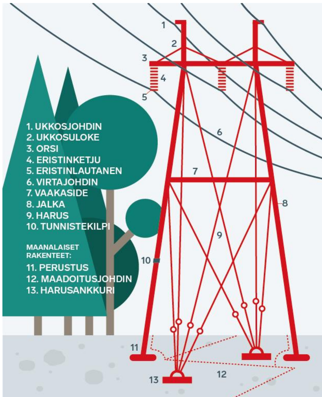
Kuva 5-6. Ilmajohdon osat (Fingrid 2024).
